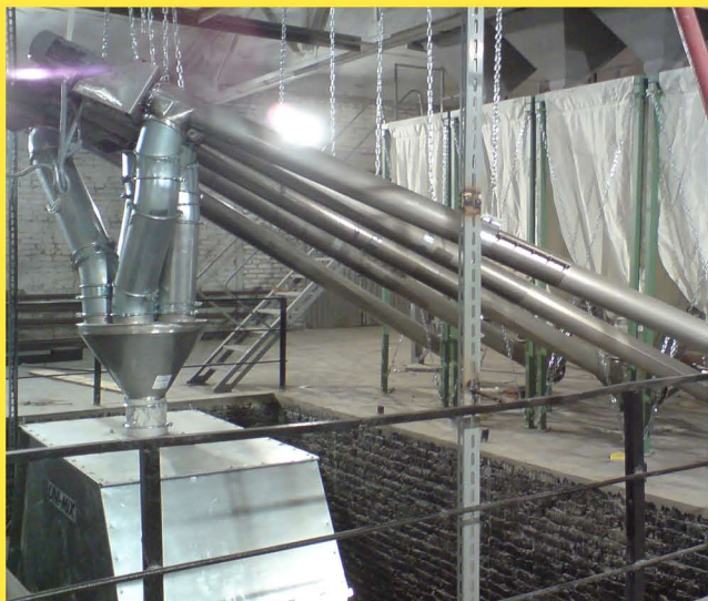
Установка для производства 3ЦМ, производительность 3,0 т/ч, Новосибирская область
