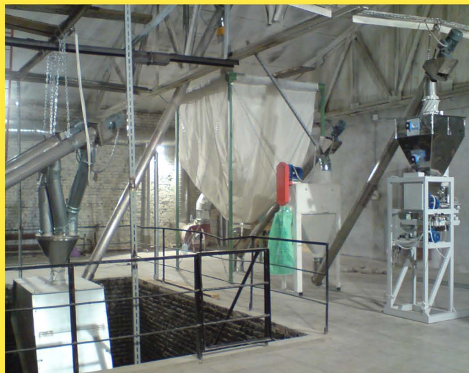
Установка для производства 3ЦМ, производительность 3,0 т/ч, Новосибирская область
