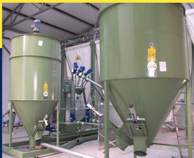
Производство комбикормов, производительность 3,7 т/ч, Ивановская область
