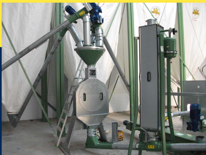
Производство комбикормов, производительность 3,7 т/ч, Ивановская область
